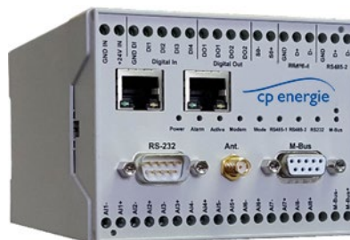
2x Ethernet-Schnittstelle für IT/OT Trennung
